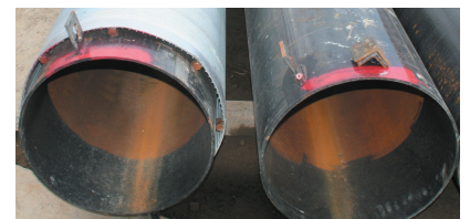
写真-1 井戸管 鋼管 φ = 500mm、スクリーン φ = 550mm、L = 6.0m (国土交通省東北地方整備局郡山国道事務所発注、塩川地区下部工工事)
