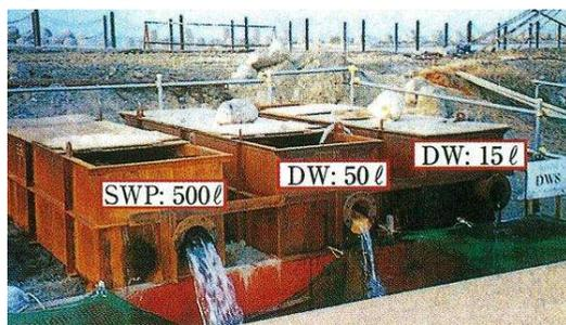
① SWP工法とDW工法の揚水量の比較
