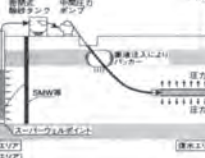
真空プレス型リチャージウェル工法は、スーパーウェルポイント工法で汲み上げた地下水を処理するため地下に圧力復水する工法。汲み上げられた地下水は空気に触らず直接、地下に復水(リチャージ)するため、従来の工法における復水時の目詰まりなどの問題点が解消された。
